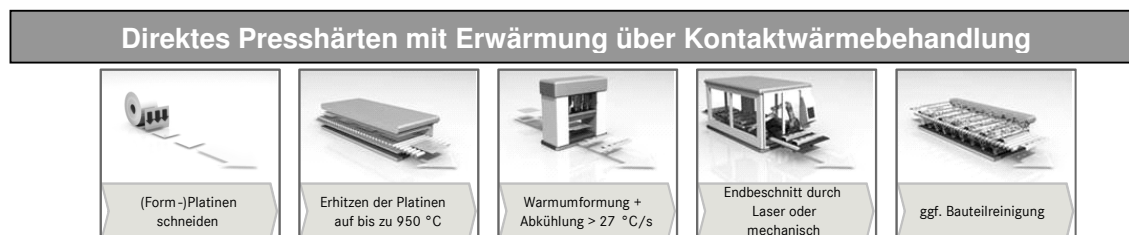
Abb. 12: Prozesskette des Presshärtens mit Platinenerwärmung durch Kontaktwärmebehandlung / process chain of press hardening with blank heating with contact heat treatment
