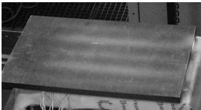
Abb. 4: Messaufbau für vollständig mit Ferriten bestückten Induktor / Testing setup for inductor with ferrites
