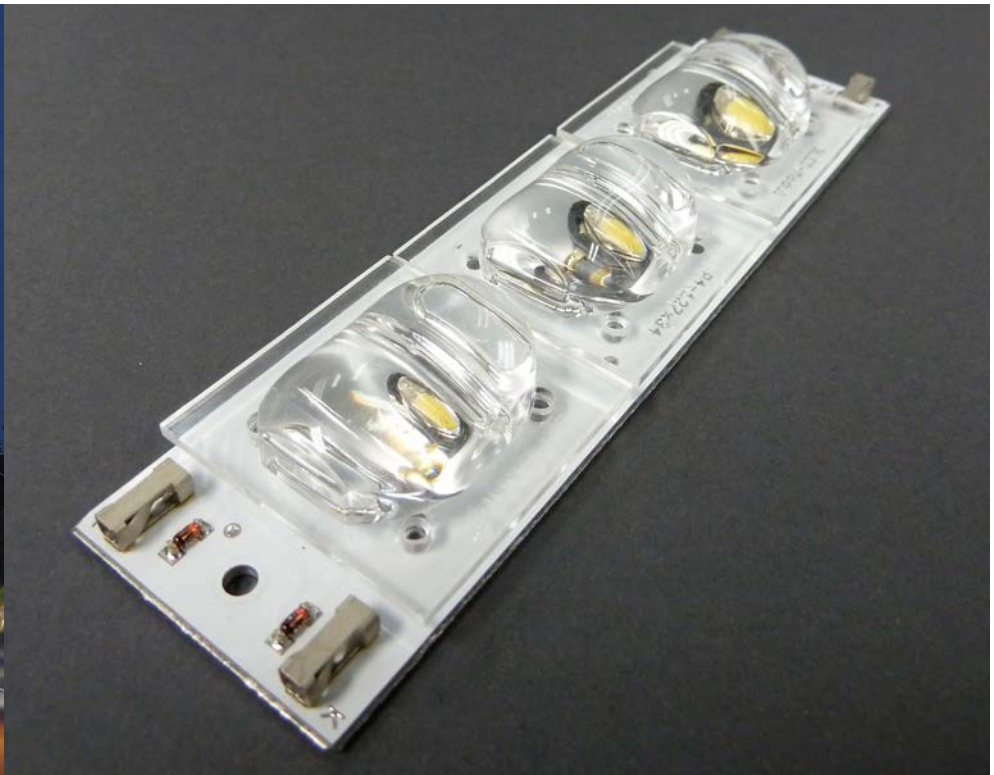
Linkes Bild: Hocheffiziente Ausleuchtung von Straßen mithilfe der OPTILIGHT-Leuchten (erste Leuchte ist alt, restliche sind neu). Rechtes Bild: OPTILIGHT-Optiken im Detail, Quellen: STAWAG AG, Innolite GmbH
