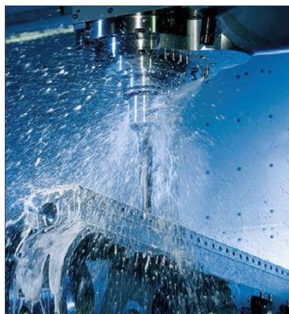
Bild 1: Umso kleiner der Werkzeugdurchmesser und umso höher der Druck des Kühlschmierstoffs ist, desto größer ist die Energieeinsparung. (Bild: Knoll)
