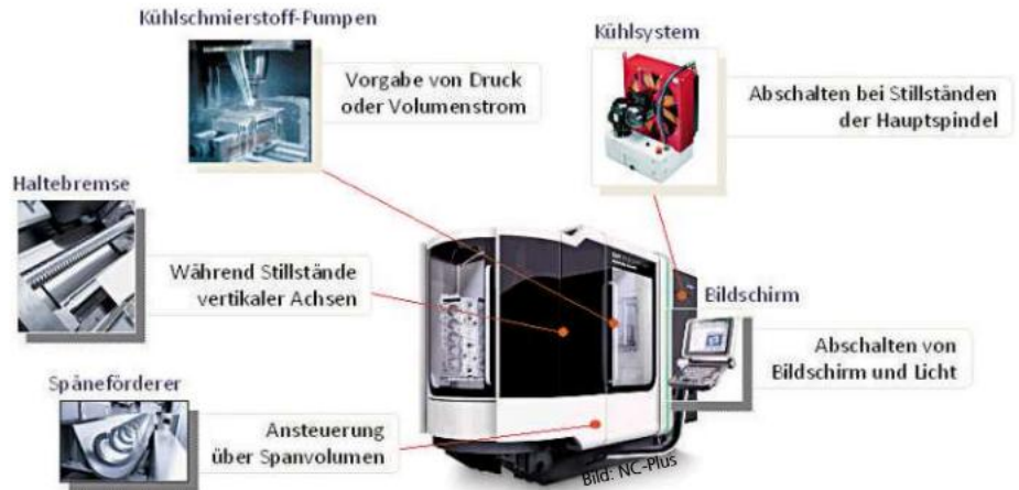
Die Steuerung des Bearbeitungszentrums DMC 80 H hat bei NC-Plus verschiedene Funktionen.
