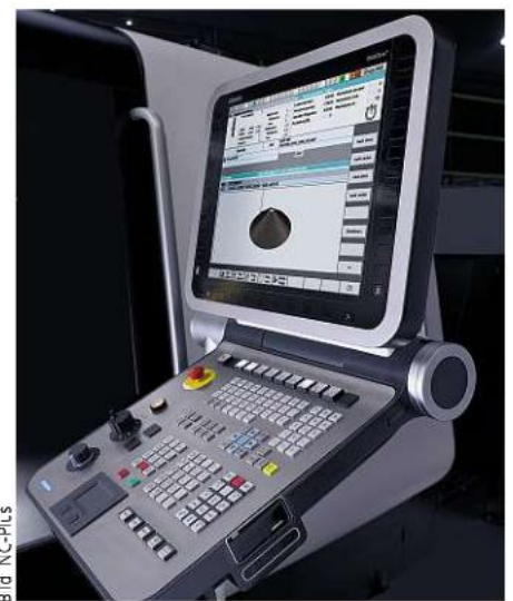
Zu den Aufgaben der Steuerung DMC 80 H zählt es, Teilsysteme der Maschine wie Kühlaggregat oder Kühlschmiermittel-Anlage gezielt in einen Stand-by-Modus zu versetzen, wenn der Prozess es erlaubt.
